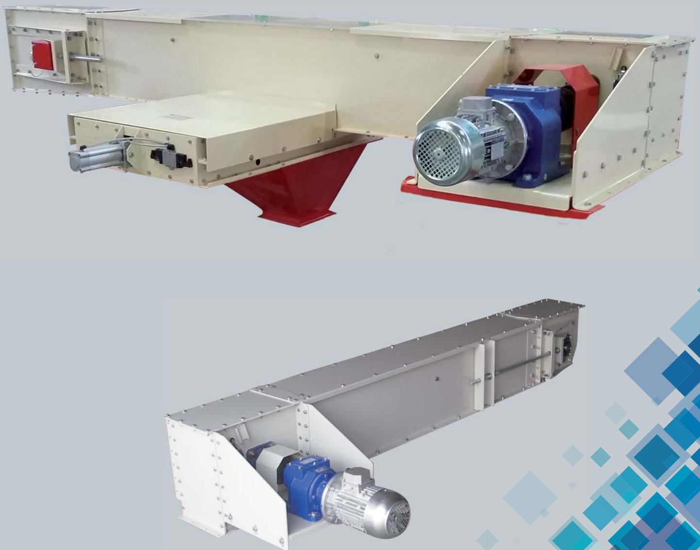
Le transporteur à chaîne est un équipement permettant la manutention ou l'extraction de produits granuleux et pulvérulents sur une trajectoire linéaire horizontale dans un caisson ou à trémie courbée équipé par une chaîne qui traîne la charge au niveau inférieur vers la sortie et retourne vide dans la partie supérieure.
